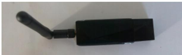
**2.8.1 使用方法：**把接收器插到 PC 端的 USB 口（标准 USB 2.0），然后打开设备的**无线扫描**菜单>无线扫描枪>按“SCAN/OK”键即可扫描商品条码并把商品条码上传到 PC 端（如果设备没有与无线接收器匹配，请参照 2.7.3 基站配对设置）。
